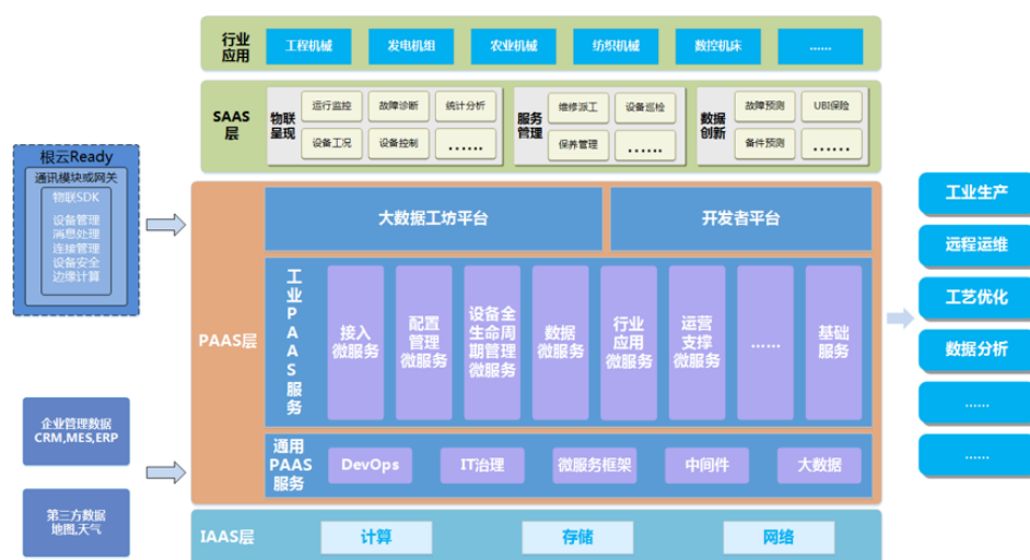
树根互联“根云”平台架构
